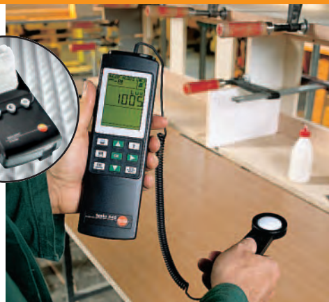
Misura dell'intensità luminosa sul posto di lavoro
