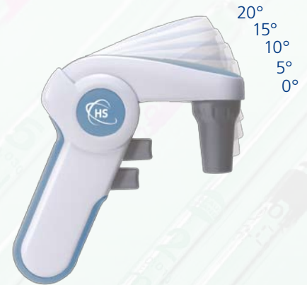
Braccio di dosaggio con angolazione regolabile su 5 posizioni
