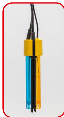
Supporto da campo a 3 fori per elettrodi
