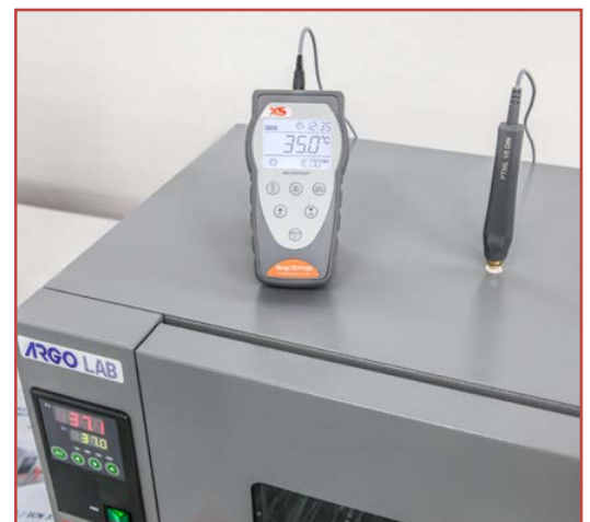
Controllo della temperatura di un incubatore
