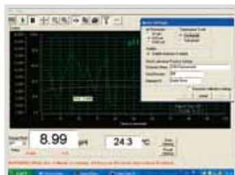
L'operatività dello strumento può essere controllata a distanza tramite il suo software di acquisizione dati e il cavo di comunicazione RS232.
