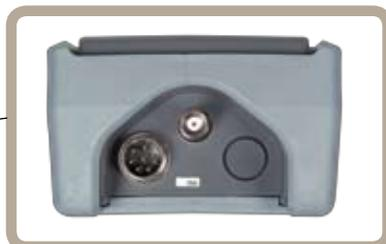
Ingressi per elettrodo pH e cella di conducibilità
