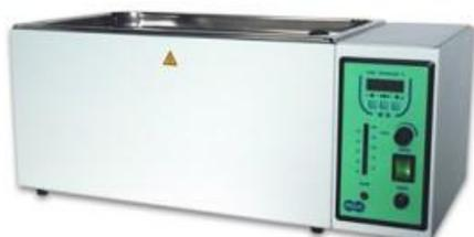
Bagno termostatico WB-MF con scuotimento tipo Dubnoff vasca costruita interamente in lamiera di acciaio completa di rubinetto di scarico.
