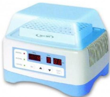
Mini-Thermociclatore E portatile, ottima combinazione caldo freddo di grande precisione, struttura in ABS antiurto e atermica completo di coperchio.
