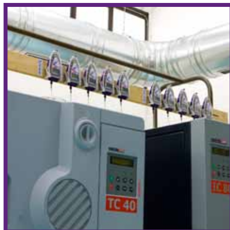
Controllo temperatura per mappatura stufe da laboratorio
