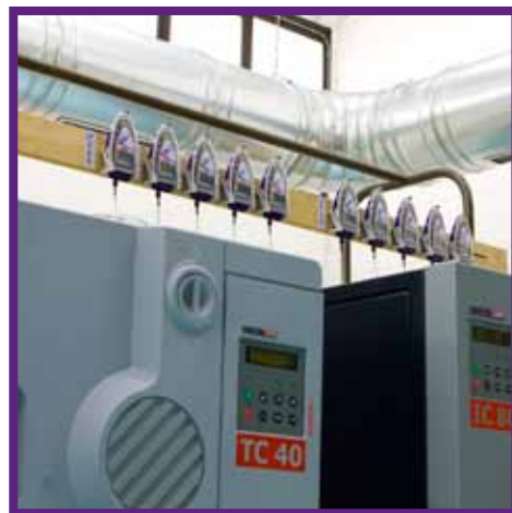
Controllo temperatura per mappatura stufe da laboratorio
