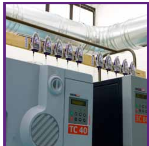
Controllo temperatura per mappatura stufe da laboratorio
