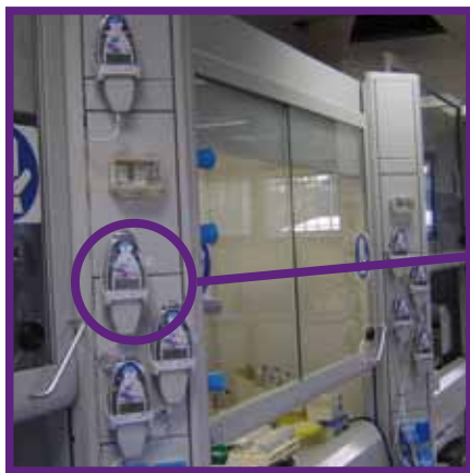
Controllo della temperatura su termoblock posti sotto cappa
