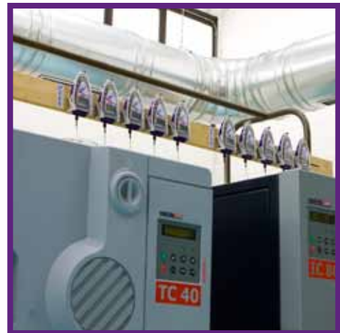
Controllo temperatura per mappatura stufe da laboratorio
