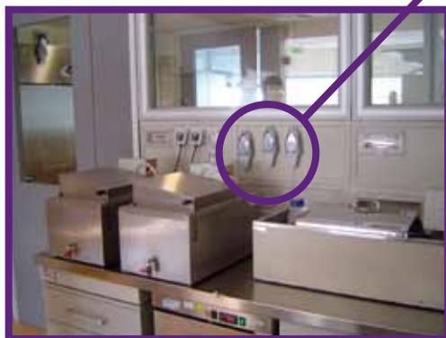
Controllo temperatura bagnomaria
