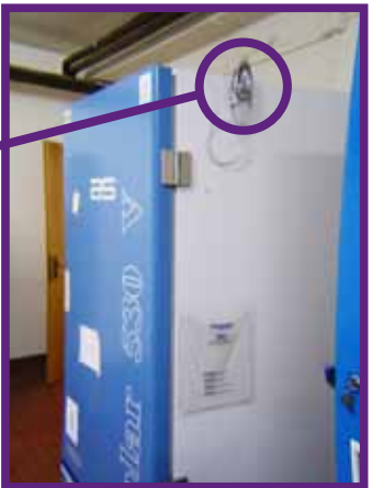
Controllo della temperatura su congelatore -80°C
