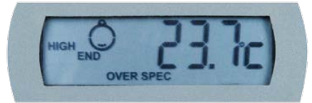
Valore max di temperatura fuori specifica
