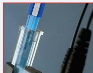
Contenitore portaelettrodo o portacella integrato. In plastica trasparente, consente la protezione dell'elettrodo di pH o della cella di conducibilità. Facilmente estraibile.
