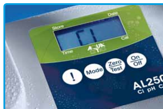
Particolare della tastiera a tenuta stagna
