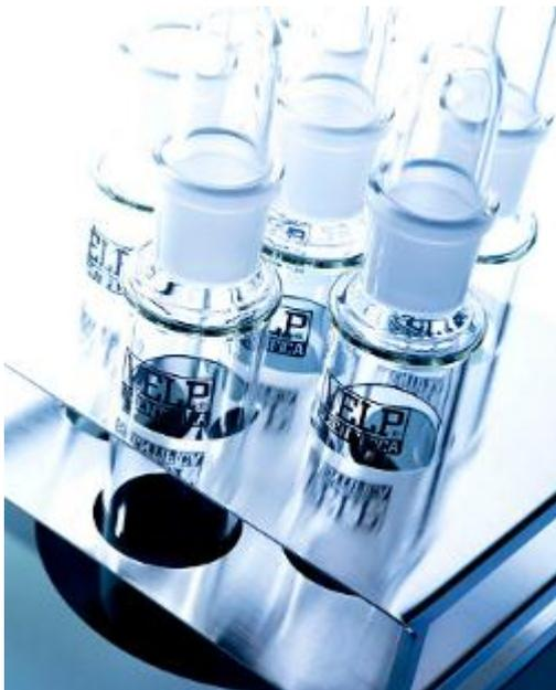
ECO 6 è stato originariamente progettato per supportare provettoni da  $\varnothing$  42 mm, ma grazie ai riduttori opzionali può essere utilizzato con 18 provette da  $\varnothing$  16 mm.
