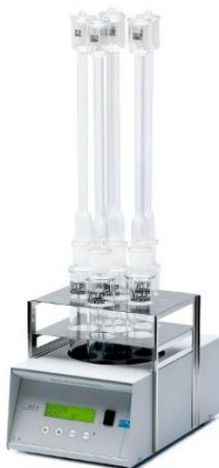
Il termoreattore ECO 6 è la soluzione ideale per l'analisi contemporanea del COD di 6 campioni da 200 ml ciascuno (secondo la metodica IRSA – CNR n°5130) e per digestioni in via umida di campioni per la determinazione di elementi metallici e non metallici in materiali organici ed inorganici (metalli, leghe, mangimi, terreni, sedimenti, tessuti, ecc.).
