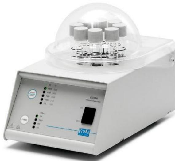
Il termoreattore ECO 8 consente di effettuare test in provetta per la determinazione di parametri come per esempio COD, composti azotati e fosforati, in assoluta **sicurezza** ed **affidabilità**, garantite da calotta di copertura delle provette, protezione sul blocco riscaldante e termostato di sicurezza.
