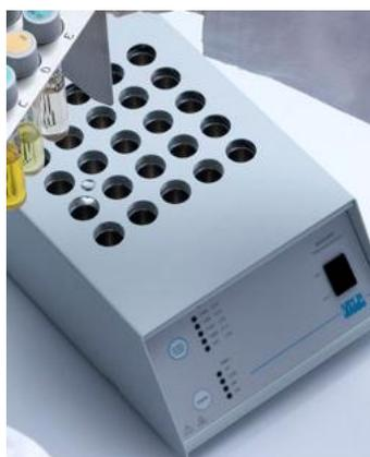
Il metodo di micro digestione **minimizza il consumo di reagenti** e riduce le attrezzature necessarie, essendoci bisogno solamente di un blocco riscaldante in grado di operare su molteplici campioni simultaneamente.
