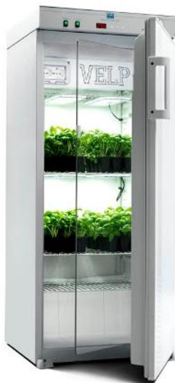
FOC 215IL è un frigotermostato dotato di **innovativo sistema di termoregolazione Auto-Tuning** e **porta interna trasparente** che permette l'esame visivo del contenuto.
