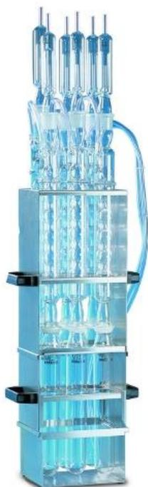
L'unità di mineralizzazione TMD 6 è progettata per digestioni, con acqua regia, di fanghi provenienti da impianti di trattamento delle acque, terreni, composti, acque reflue o materiali vegetali.
