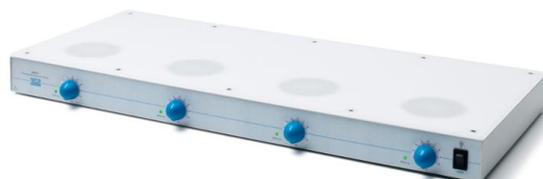
AMI è un agitatore magnetico **illuminato** particolarmente utile per le titolazioni in cui sono necessarie condizioni di luce ottimale, per la buona visualizzazione del punto finale di viraggio.
