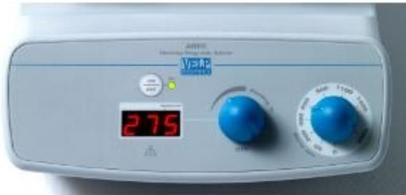
Il display digitale risulta **chiaramente leggibile**, mostrando costantemente a temperatura impostata dall'operatore. Ruotando la manopola sinistra è possibile regolare la **temperatura (fino a 550 °C)**, mentre con quella destra si agisce sull'**agitazione (fino a 1500 rpm)**.
