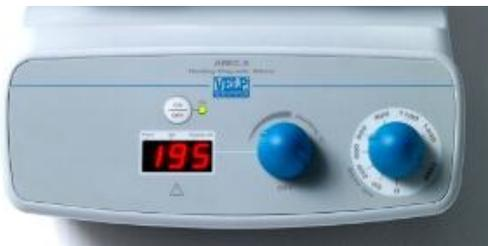
Il display digitale risulta **chiaramente leggibile**, mostrando costantemente a temperatura impostata dall'operatore. Ruotando la manopola sinistra è possibile regolare la **temperatura (fino a 550 °C)**, mentre con quella destra si agisce sull'**agitazione (fino a 1500 rpm)**.
