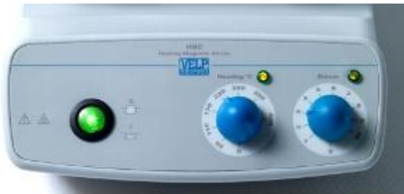
Ruotando la manopola sinistra è possibile regolare la **temperatura (fino a 400 °C)**, mentre con quella destra si agisce sull'**agitazione (fino a 1300 rpm)**.
