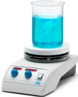
La particolare piastra **CerAlTop™**, in lega di alluminio rivestita da uno strato ceramico, assicura una **formidabile omogeneità della temperatura** su tutta la superficie della piastra stessa, fino a 370 °C e al tempo stesso una eccellente **resistenza** agli agenti chimici e **facilità di pulizia**.
