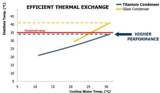
L'innovativo condensatore in titanio di VELP garantisce elevate prestazioni e un notevole risparmio di acqua (consumi da 0,5 l/min). Il grafico mostra l'elevata efficienza del condensatore in titanio rispetto a quello tradizionale in vetro. È importante notare che, anche ad una temperatura di 30 °C, il condensatore in titanio assicura una temperatura del distillato sempre al di sotto del valore soglia (35 °C), come indicato nel metodo Kjeldahl.
