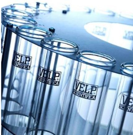
L'ingegnerizzazione studiata nei minimi dettagli garantisce un'**elevata indipendenza e flessibilità**, potendo supportare due diversi modelli di carosello, da 24 provettoni standard (250 ml) o da 21 Jumbo (400 ml). I provettoni contenenti i campioni digeriti sono trasferiti dal carosello all'analizzatore Kjeldahl in modo completamente automatico, per **risultati precisi ed affidabili**.
