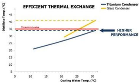
L'**innovativo condensatore in titanio** di VELP garantisce elevate prestazioni e un notevole risparmio di acqua (consumi da 0,5 l/min). Il grafico mostra l'elevata efficienza del condensatore in titanio rispetto a quello tradizionale in vetro. È importante notare che, anche ad una temperatura di 30 °C, il condensatore in titanio assicura una temperatura del distillato sempre al di sotto del valore soglia (35 °C), come indicato nel metodo Kjeldahl.
