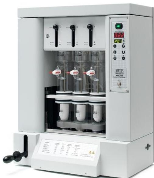
Le unità **SER 148** permettono la separazione quantitativa di una sostanza o di un gruppo di sostanze (es. grasso) da una miscela di solidi o semisolidi. L' estrazione avviene in accordo alla **tecnica Randall**, che opera in due fasi, più una di recupero del solvente distillato. Questa tecnica ha tre grandi vantaggi rispetto alla tecnica tradizionale Soxhlet:
