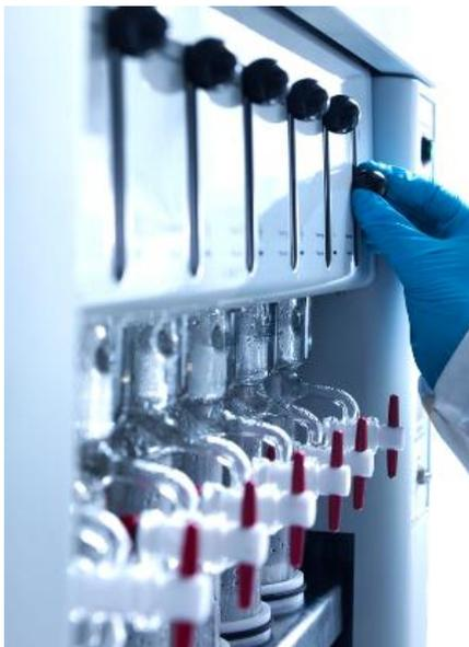
Estrazioni a solventi singole o multiple con metodo Randall: una miglioria della più nota tecnica Soxhlet, che prevede l'utilizzo di solventi caldi, riducendo i tempi di analisi. Infatti, questa tecnica garantisce una **solubilizzazione rapida** grazie al solvente caldo, che permette di ridurre i tempi di estrazione a circa 90 minuti.
