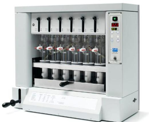
Le unità **SER 148** permettono la separazione quantitativa di una sostanza o di un gruppo di sostanze (es. grasso) da una miscela di solidi o semisolidi. L' estrazione avviene in accordo alla **tecnica Randall**, che opera in due fasi, più una di recupero del solvente distillato. Questa tecnica ha tre grandi vantaggi rispetto alla tecnica tradizionale Soxhlet:
