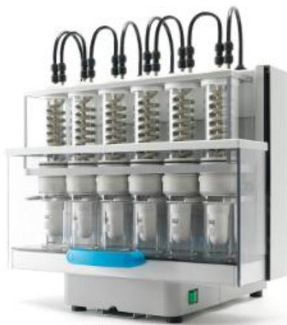
Un estrattore completamente automatico che garantisce elevate prestazioni, velocità, accuratezza e precisione nella determinazione di materia estraibile in accordo con le tecniche Randall e Twisselman mediante l'impiego delle migliori tecnologie disponibili ed in completa sicurezza.
