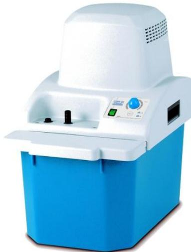
JP è una pompa a ricircolo d'acqua che permette la selezione di due diverse modalità di programmazione, garantendo **un'aspirazione ottimale** in funzione delle fasi di digestione e del numero di campioni del digestore alla quale la pompa viene collegata.
