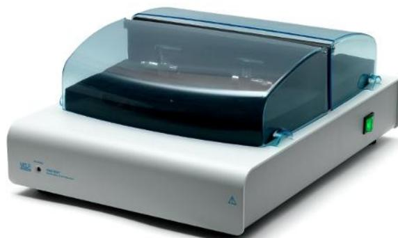
OXITEST è una soluzione innovativa, interamente controllata dal potente OXISoft™ ed in grado di fornire **informazioni ad alto valore aggiunto** sui processi di ossidazione dei grassi negli alimenti, oli e grassi. Il vantaggio principale di OXITEST consiste nella realizzazione del **test di stabilità direttamente sull'alimento completo**, senza una preliminare separazione dei grassi contenuti.
