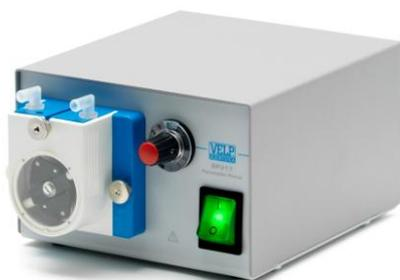
SP 311 è una pompa peristaltica monocanale a **portata variabile** in grado di aspirare fino a 10 metri di profondità. E' dotata di tubo resistente alla maggior parte dei prodotti chimici e disponibile in due diametri.
