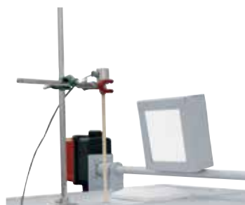
Deflettore per aria viziata e termocoppia della carica con cavalletto come dotazione aggiuntiva
