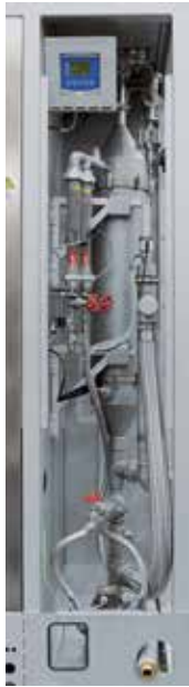
Depuratore dei gas di scarico per la pulizia dei gas di processo mediante lavaggio
