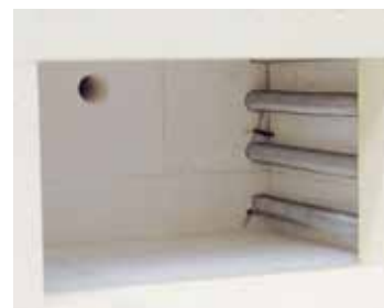
Vano forno con isolamento resistente in mattoni refrattari leggeri
