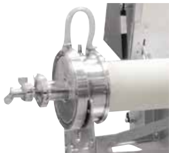
Flange in acciaio inox raffreddate ad acqua
