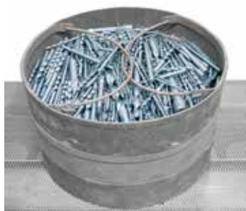
Ricottura blu di alesatori con vapore acqueo in un forno della serie NRA
