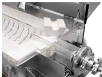
Adattatori per il funzionamento alternato con tubo di lavoro o reattore di processo
