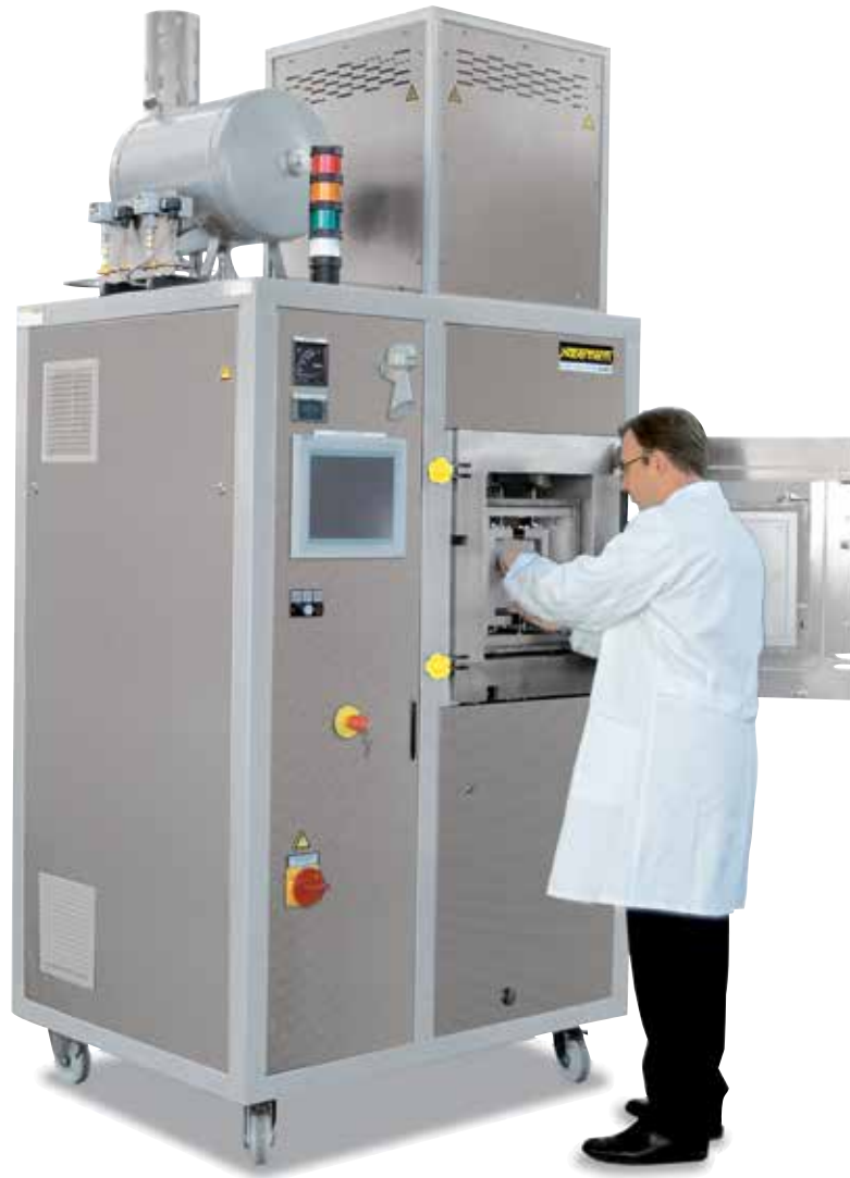
VHT 8/16 MO con sistema supplementare Idrogeno e cassetta di processo
