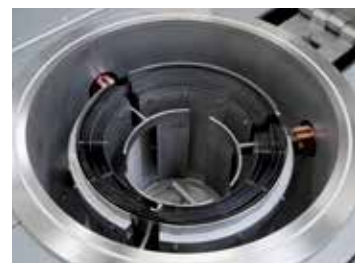
Storta cilindrica con riscaldamento al tungsteno
