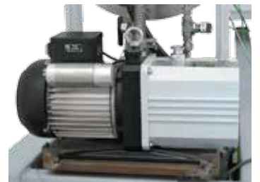
Pompa a vuoto per evacuazione a freddo della storta
