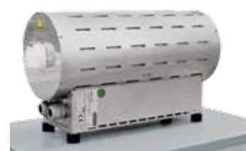
Forno tubolare con regolazione a cinque zone per una uniformità della temperatura
