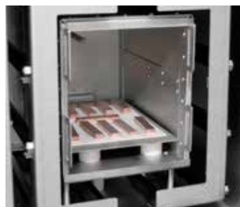
Trattamento termico di barrette di rame con idrogeno in VHT 08/16 MO
