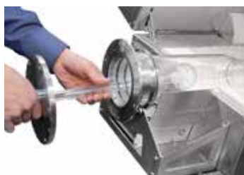
Tappi di chiusura a tenuta di gas per tubo in vetro di quarzo chiuso su un lato
