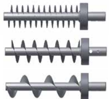
Coclee con passi diversi per l'adattamento della quantità trasportata
