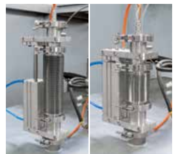
Termocoppia di tipo S con dispositivo di estrazione automatica per ottimi risultati di regolazione nel campo di temperatura inferiore
