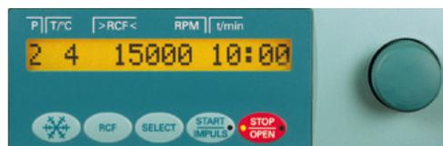
Il display e tutti i controlli sulle centrifughe MIKRO 220 e 220 R sono stati progettati per la miglior facilità d'uso. Le informazioni sul display sono posizionate con chiarezza e perfettamente leggibili. Durante la centrifugazione i valori dei parametri effettivi vengono indicati. La combinazione dei parametri registrati rimangono nella memoria della centrifuga anche se questa viene spenta.
