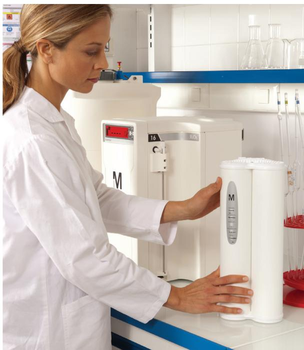
I sistemi RiOs™ Essential Merck Millipore sono stati sviluppati per assicurare un'erogazione affidabile e costante d'acqua pura di Tipo 3 d'elevata qualità. Essi riuniscono diverse tecniche di purificazione dell'acqua complementari che comprendono **pretrattamento** e osmosi inversa con membrane **dalle elevate prestazioni**.
