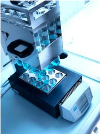
Il blocco riscaldante dei DKL è interamente realizzato in lega di alluminio, il materiale in assoluto migliore in quanto a precisione, stabilità ed omogeneità di temperatura. Anche in termini di **ripetibilità e di conducibilità termica**, l'alluminio offre prestazioni di altissimo livello!
