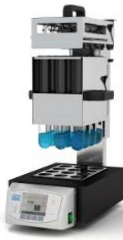
I digestori DKL sono completamente automatici ed immediatamente **pronti all'uso**, poiché composti da un blocco riscaldante in alluminio (che offre **eccellente omogeneità, precisione e accuratezza della temperatura**), un lift per la movimentazione dei campioni in automatico, la cappa di aspirazione, provettoni, rack portaprovettoni e vaschetta raccogli-gocce.
