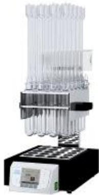
La serie DKL è sempre più **versatile!** In particolare il modello **DKL 20**, che può essere utilizzato anche per svolgere l'analisi **COD (Chemical Oxygen Demand)**: il suo lift è infatti in grado di movimentare automaticamente tutta la vetreria richiesta per l'analisi, gestendo 20 campioni simultaneamente!
