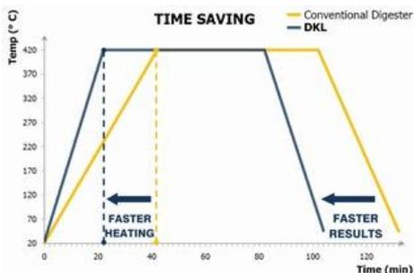
Il grafico mostra che aumentando la velocità di riscaldamento del blocco, anche l'intera analisi avrà durata minore! Tutti i vantaggi di un riscaldamento rapido abbinati ai noti benefici di un digestore a blocco: eccellente affidabilità, notevole omogeneità e precisione della temperatura e possibilità di determinare la temperatura reale cui avviene la digestione.
