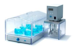
La procedura analitica per la determinazione della fibra dietetica prevede inizialmente una serie di digestioni del campione tramite enzimi termostabili utilizzando il digestore enzimatico GDE, che opera in accordo alla metodica ufficiale AOAC per la determinazione della fibra dietetica totale.
