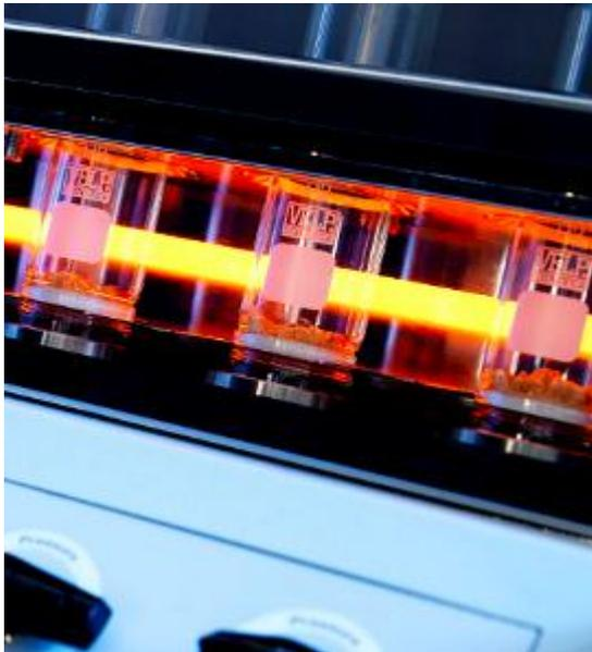
Efficienza massima grazie ad una particolare velocità di riscaldamento che garantisce un rapido riscaldamento del campione, precedentemente mischiato con i reagenti pre-riscaldati.
